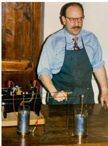
Foto 6: primi anni 1990; altro momento di Paolo Brenni, sempre alla Fondazione Scienza e Tecnica di Firenze, nella dimostrazione della misura delle ONDE STAZIONARIE mediante le "LINEE DI LECHER", alla presenza di altri soci A.I.R.E.. L'esperimento fu seguito da un buon pranzo, alla gloria della cucina fiorentina. (foto di Gianni Dino)
